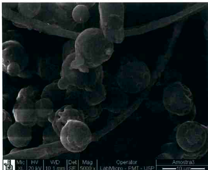
Figura 25 - Micrografia obtida por MEV da manta 2 (PHB-PEG a 9,9% e PEO-200K 1,0%) com aumento de 5000x.
