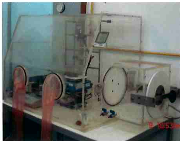
Figura 10 - Glove Box onde foi realizada a mistura dos polímeros [26]
