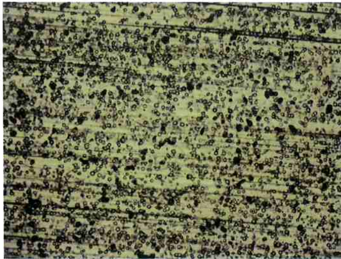
Figura 23 - Micrografia obtida por MO da manta 2 (PHB-PEG a 9,9% e PEO-200K 1,0%) com aumento de 200x.
