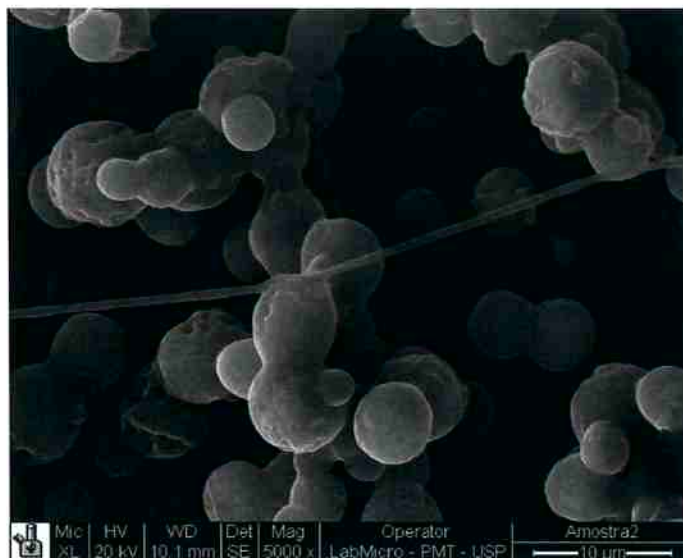
Figura 22 - Microscopia eletrônica de varredura da primeira solução (PHB-PEG a 10%) eletrofiada com aumento de 5000x
