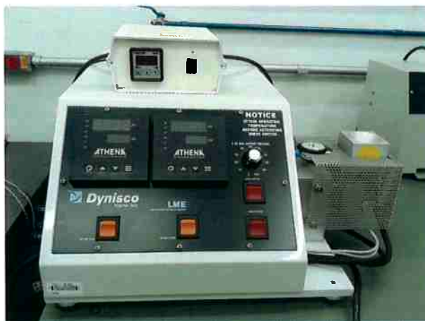
Figura 11 - Extrusora utilizada para a reação entre os polímeros
