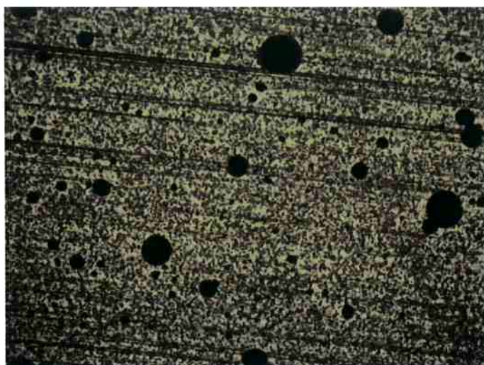
Figura 19 - Micrografia obtida por MO da primeira solução (PHB-PEG a 10%) eletrofiada com aumento de 200x.
