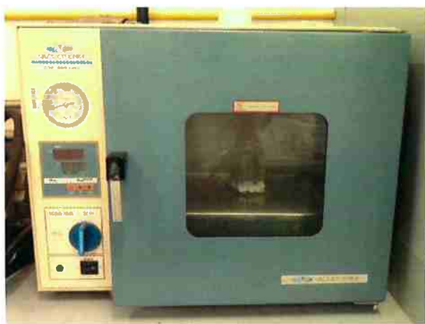
Figura 13 - Secagem a vácuo do copolímero em temperatura ambiente.
