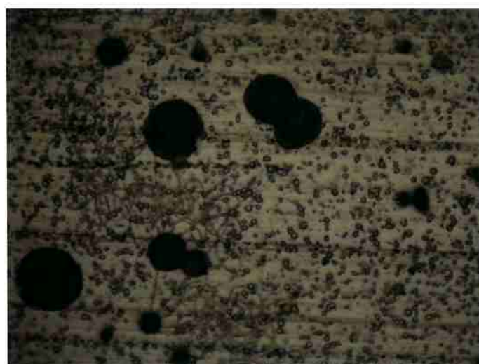
Figura 20 - Micrografia obtida por MO da primeira solução (PHB-PEG a 10%) eletrofiada com aumento de 500x
