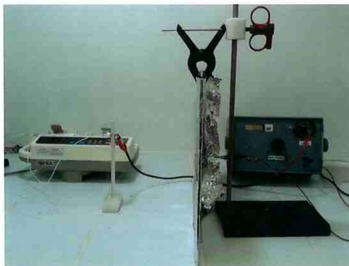
Figura 14 – Sistema de eletrofiação utilizado neste estudo
